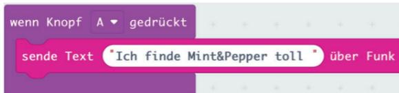
Jeder micro:bit, der sich in der Nähe befindet kann diese Nachricht empfangen.
